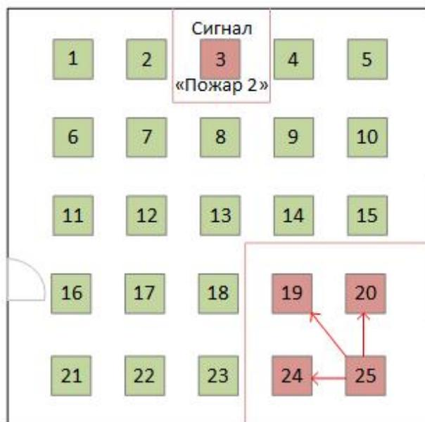
Алгоритм пуска, когда сигнал «Пожар 1» поступил с извещателя №25. Срабатывает пуск по привязке АУ №25, пуск АУ №3 без привязок
