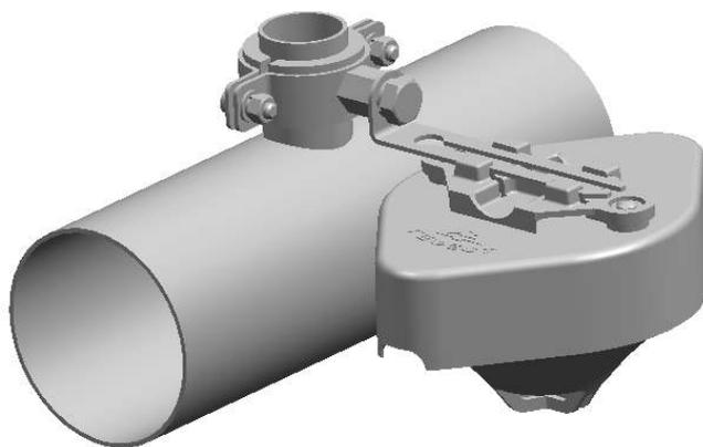
Рисунок 105 – Пример установки ИПТ-СИ-л и МКС-И-л на кронштейн.
