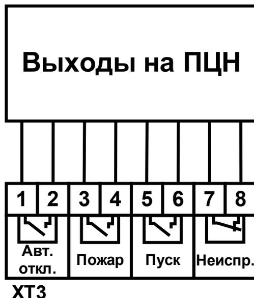
Рисунок 22 – Контакты для подключения выходов на ПЦН.
